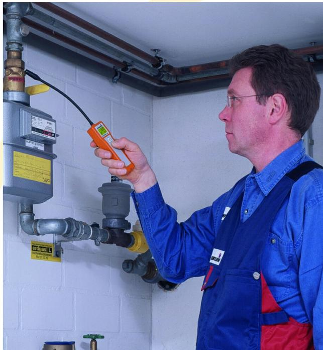
Lo Snoopers Mini è un robusto rivelatore palmare per uso professionale per la ricerca di microfughe gas su condotte a vista e la verifica di lavori di manutenzione e riparazione.
